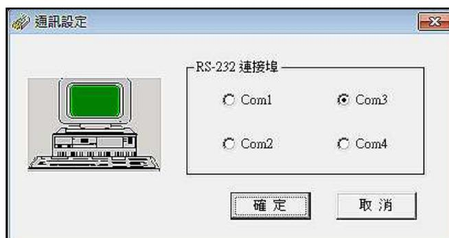
◆一般使用 RS-232 傳輸線預設為 Com1，若使用 USB 轉 RS-232 傳輸線，可在裝置管理員看是哪一個 COM 埠，如左圖所示：
